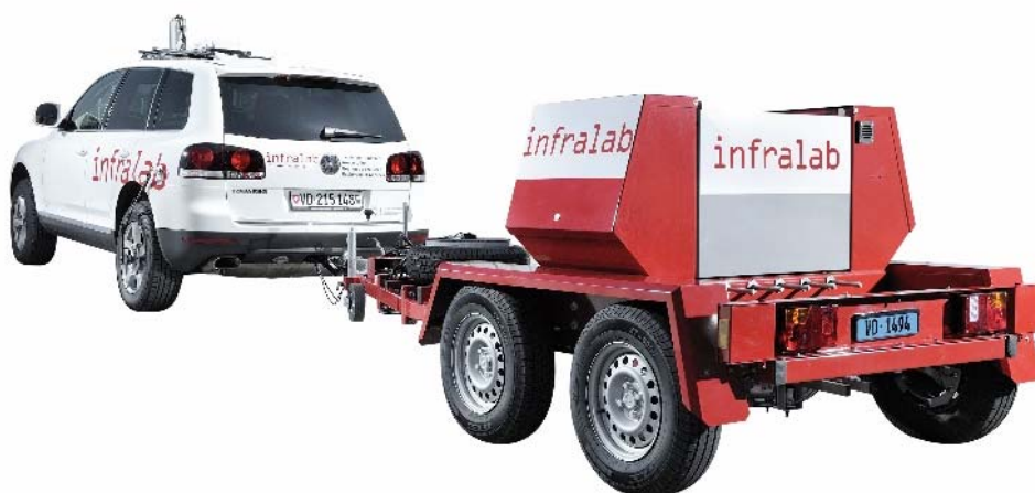
Fig 2.5 – Matériel de mesure, ici le HWD (source : Infralab)
