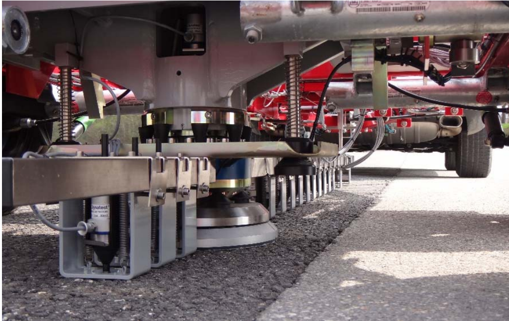
Fig 2.6 – Positionnement de la plaque de mesure et des géophones du FWD (source : Infralab)
