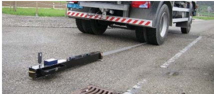
Fig 2.1 – Poutre Benkelman (source : IMP Baustest AG)
