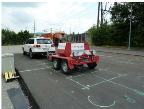
Abb. 14 FWD Nullmessung auf dem Prüffeld durch die Firma Infralab SA aus Lausanne (Links) und Endmessung mit der FWD des Universität Parma (Rechts)
