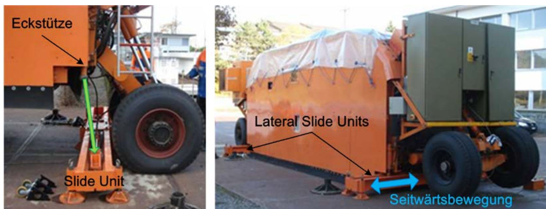
Abb. 4 Lateral Wandering Zusatzsystem und Bezeichnungen
