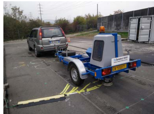
Abb. 14 FWD Nullmessung auf dem Prüffeld durch die Firma Infralab SA aus Lausanne (Links) und Endmessung mit der FWD des Universität Parma (Rechts)
