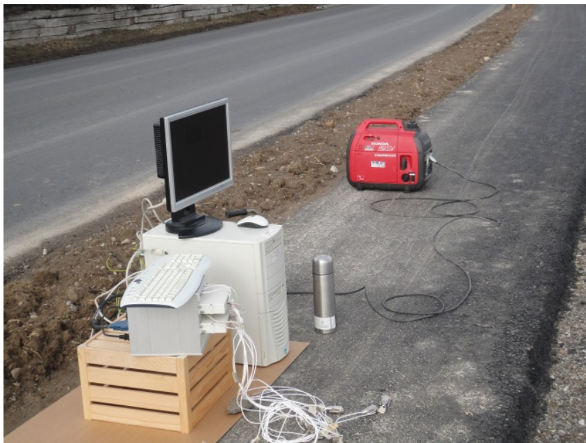
Abb. 22 Aufgebautes Messsystem während den Überrollungen
