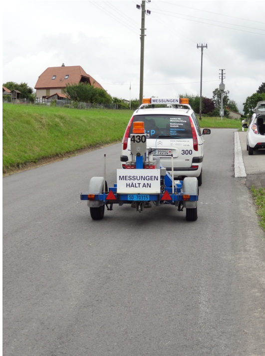
Abb. 34 Zugfahrzeug und FWD-Messanhänger zur Durchführung der Tragfähigkeitsmessungen
