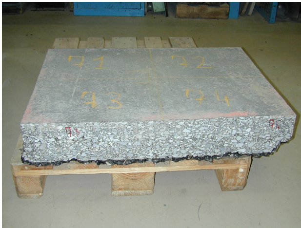
Abb. 44 Ausbruchsstück aus den Testfeldern zur Durchführung der Bestimmung des E-Moduls und der Steifigkeit
