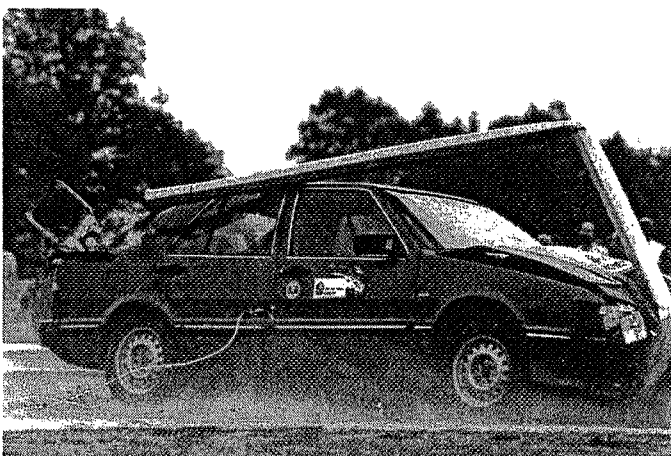
Abb 14 Anprall an Beleuchtungs- kandelaber aus achteckförmiger Blechkonstruktion [28]
