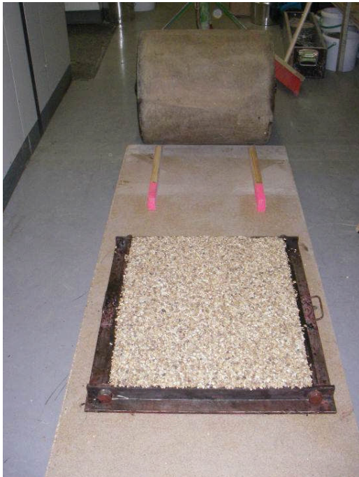
Abb. 28 Gussasphalt-Versuchsplatte nach Abwalzen des Abstreusplitts
