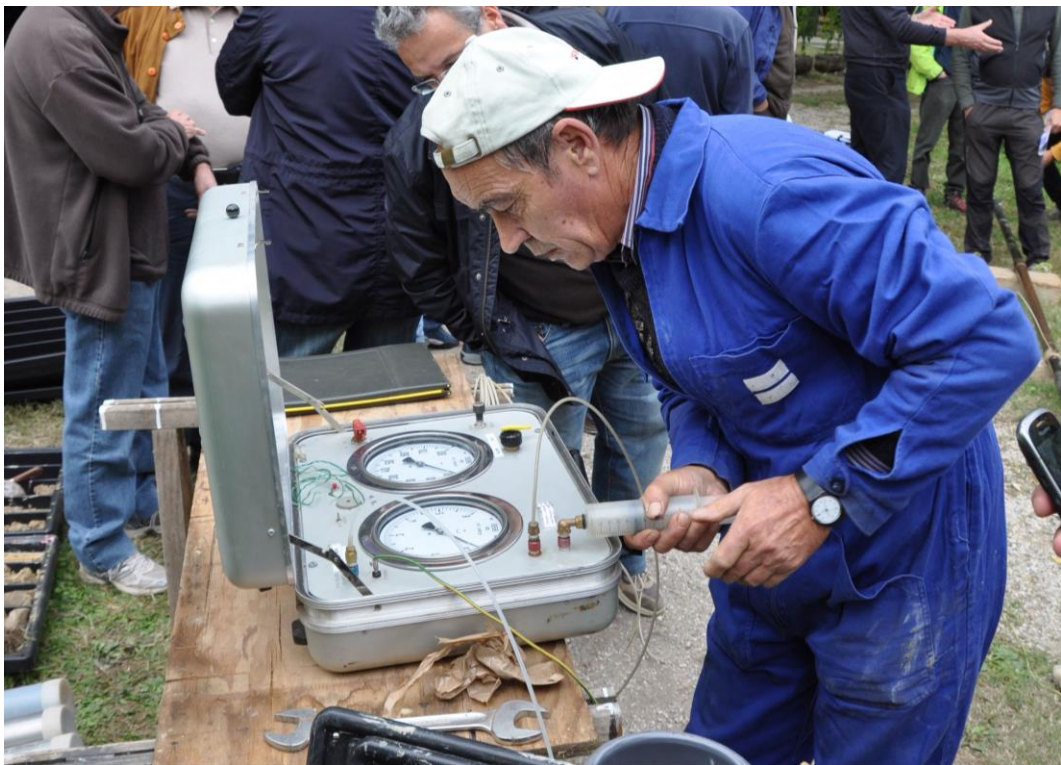
Abb. V-5 Kalibrierung der Ablesekorrekturen des Flachdilatometers.
