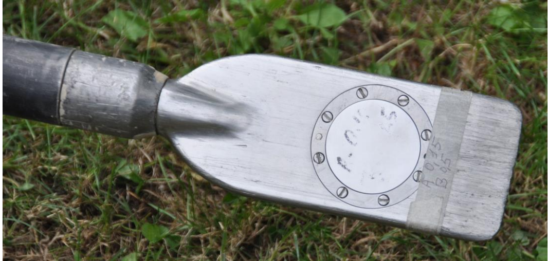
Abb. V-1 Flachdilatometer DMT an Gestänge geschraubt vor Einsatz im Feld (mit Angabe der Resultate der Kalibrierungsmessungen).
