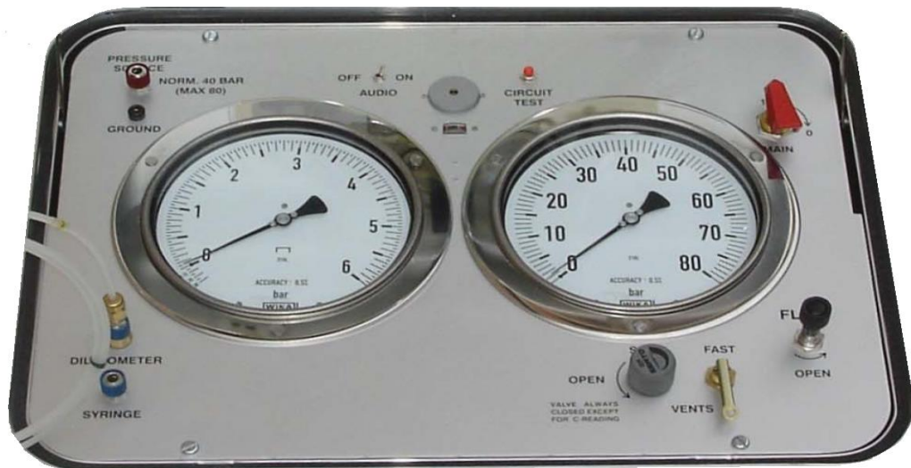
Abb. V-7 Das Kontrollgerät des Flachdilatometers DMT (manuelle Ablesung).
