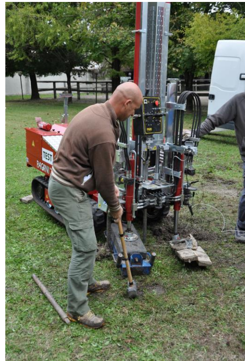
Abb. 11 Durchführung eines SCPT Versuchs mit Hammerschlag an Geländeoberfläche.
