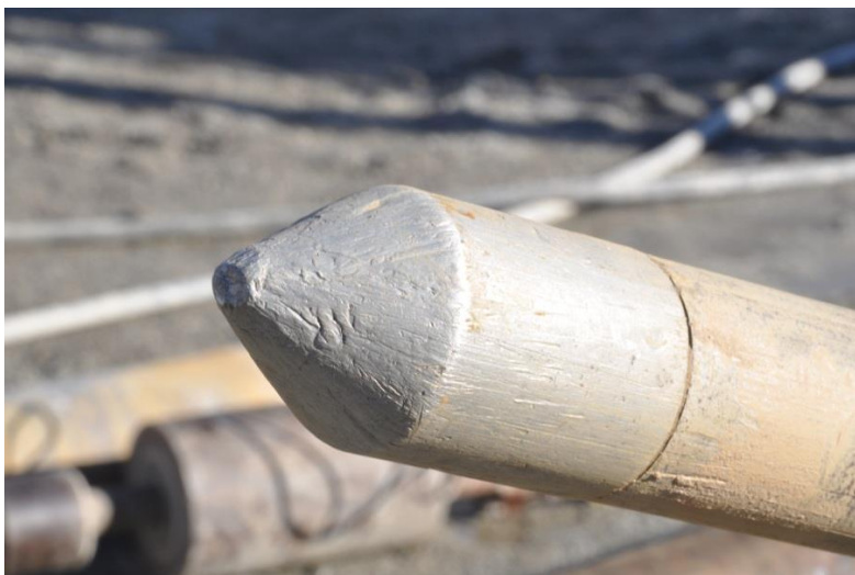
Abb. 6 Geschlossene SPT Spitze (SPT-C) nach Verwendung in Kies.
