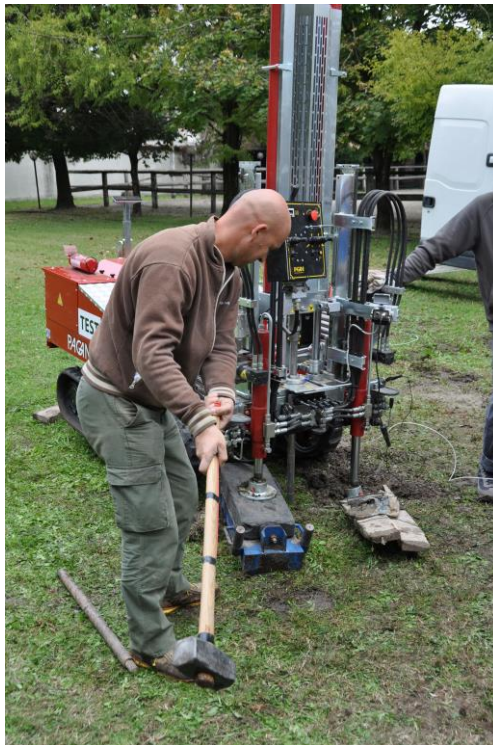
Abb. 11 Durchführung eines SCPT Versuchs mit Hammerschlag an Geländeoberfläche.
