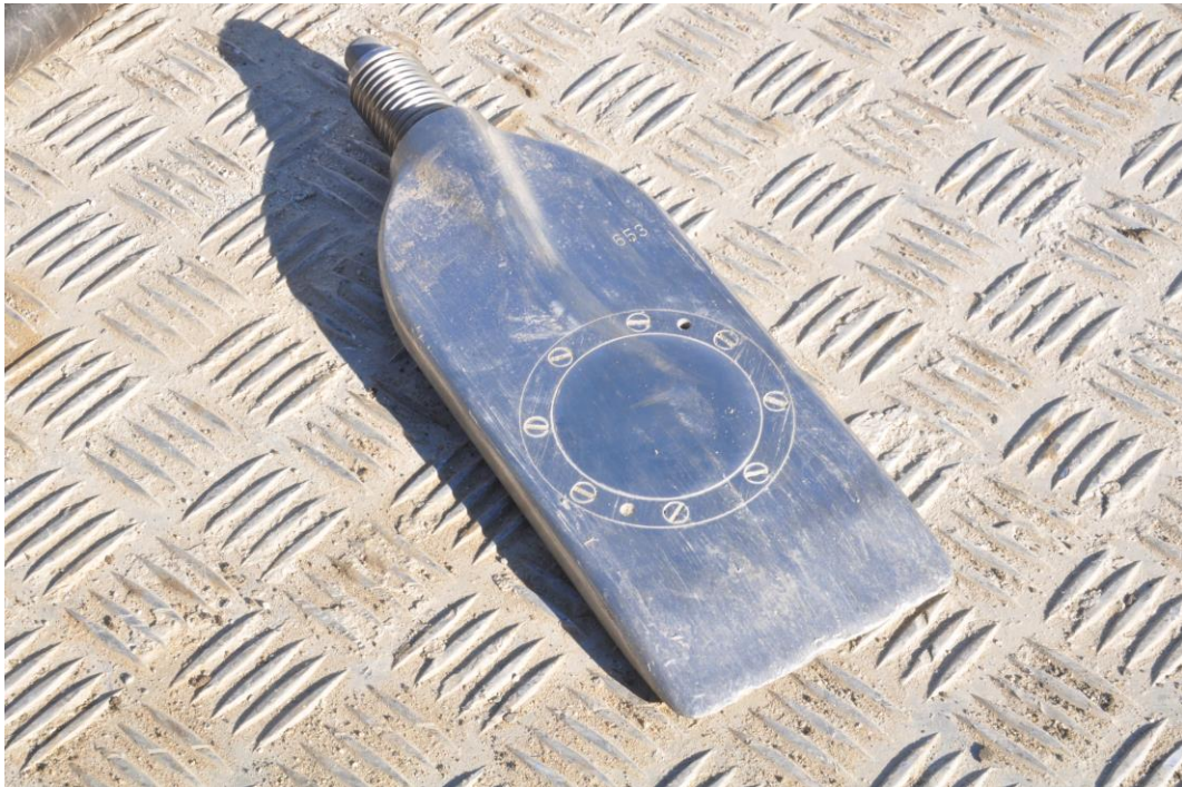
Abb. 12 Flachdilatomer DMT mit Ritzspur auf der Membrane.
