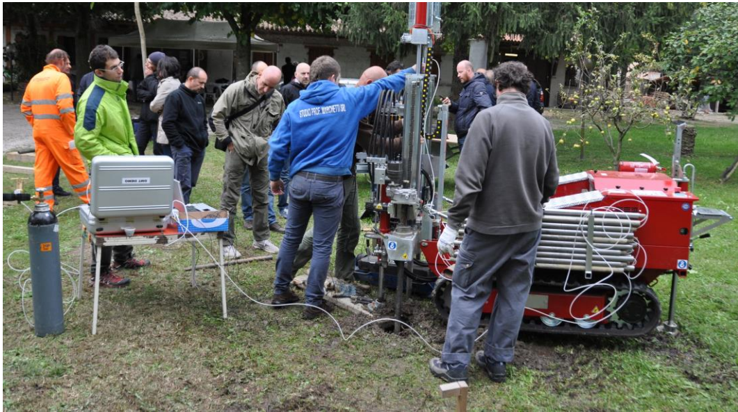
Abb. V-4 DMT Ablesegerät, Gasflasche neben Gerät zum Einpressen des Flachdilatometers DMT.
