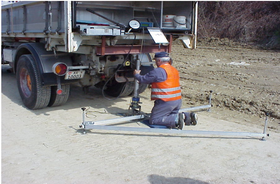
Abbildung A2-18: Statischer Plattendruckversuch. Der Druckstempel wird unter die Gegenlast (LKW) gestellt. Im Weiteren ist das Stativ zu sehen, an dem die Setzungsmessuhr befestigt ist und daher nicht im Einflussbereich der Setzungsmulde liegen darf.
