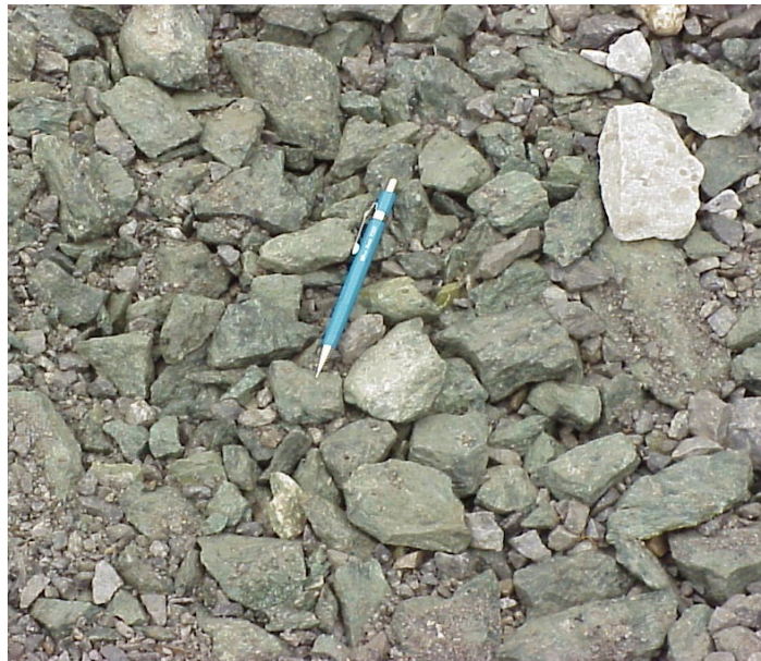
Abbildung A2-6: Fundationsschicht in Rona. Es handelte sich um gebrochenes Material mit einem sehr geringen Feinanteil ( \varnothing < 0.06 \text{ mm} ) von 1%. Unter diesen Bedingungen (kleiner Feinanteil und Wassergehalt annähernd null) kann das Bodenmaterial mit einer dynamisch angeregten Walze nicht verdichtet werden.
