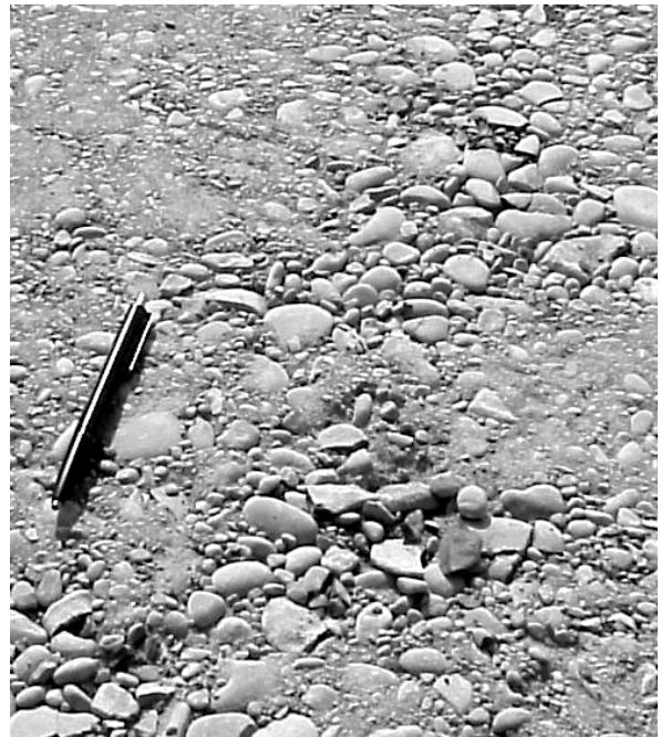
Abbildung 5-14: Oberfläche nach Ende der Verdichtung Spur Ammann.
