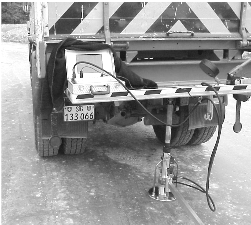
Abbildung 5-1: Statischer Plattendruckversuch mit direkter Erfassung der Messwerte mit dem Computer.
