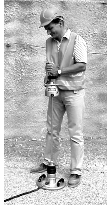
Abbildung 3-2: Dynamischer Plattendruckversuch (Fallgewichtsgesetz).
