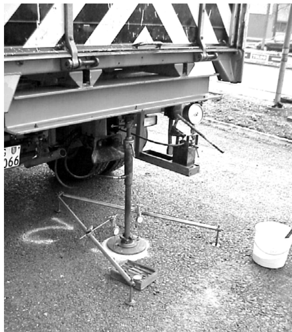
Abbildung 3-1: Statischer Plattendruckversuch. Damit die Lastplatte satt aufliegt wird eine dünne Schicht Sand auf die Prüffläche aufgebracht.
