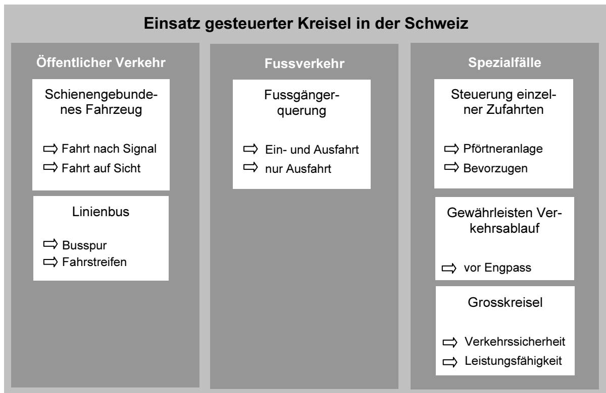
Abbildung 4: Einsatzmöglichkeiten gesteuerter Kreisel
