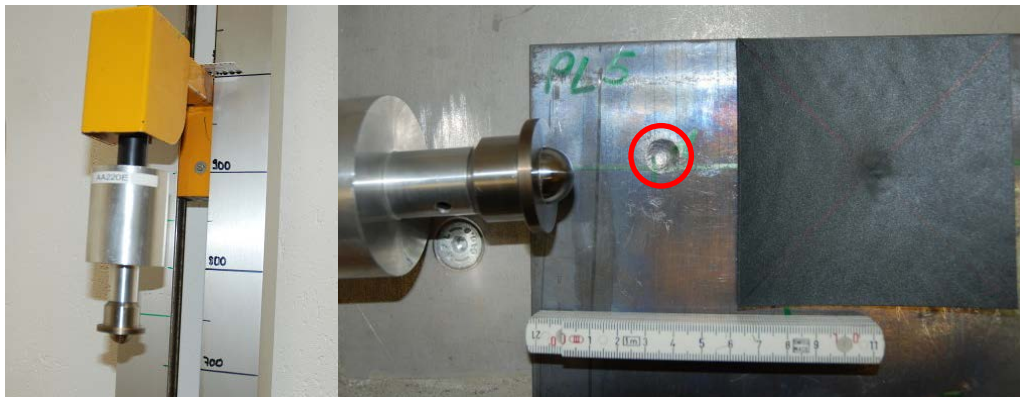
Abb. 3: links: eingespannter Prüfkopf (EN ISO 13428) vor dem Falltest, rechts: die Stossenergie führt zu einer plastischen Verformung der Bleiplatte (roter Kreis)
