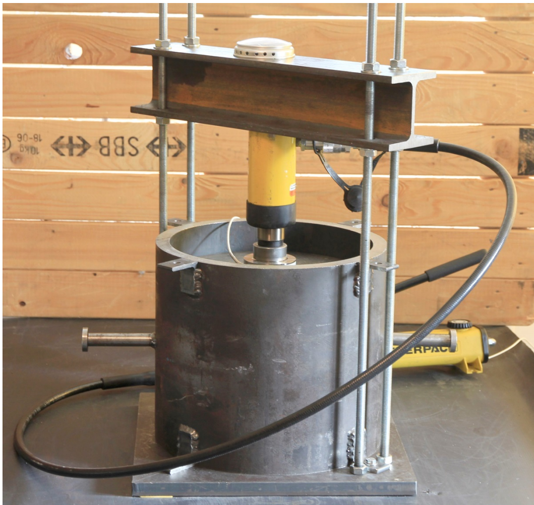
Abb. 5: Prüfzylinder zur Bestimmung der langfristigen Schutzwirksamkeit nach EN 13719. Das weisse Kabel verbindet Kraftmessdose und Messeinrichtung (PC)
