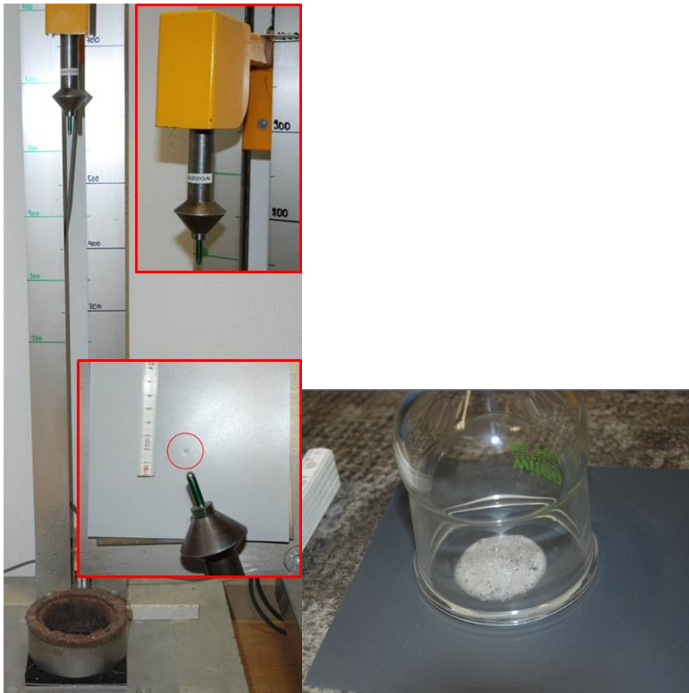
Abb. 2: Versuchsstand nach SIA 272 Anhang D.3.1, Prüfkegel in Ausgangsposition vor dem Falltest. Der Durchstoss in der Kunststoffdichtungsbahn (KDB, Oberseite helle Signalschicht) wird mittels Unterdruck und Seifenlauge an der Rückseite auf Dichtheit untersucht. Die KDB ist undicht.
