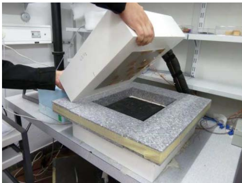
Fig. 3.19 Guarded hot-plate apparatus.
