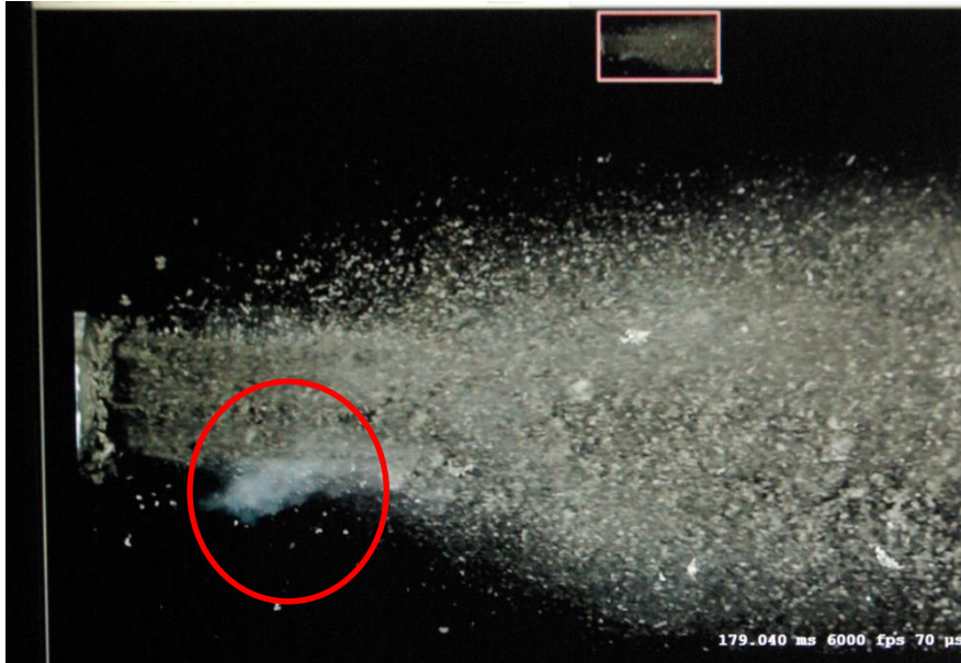
Abb.35 Spritzbetonaustritt an Düse (Aufnahme mit Hochgeschwindigkeitskamera)
