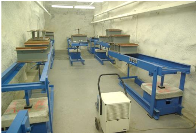
Abb.9 Prüfstände zur Kriechprüfung an Quadratplatten im VersuchsStollen Hagerbach
