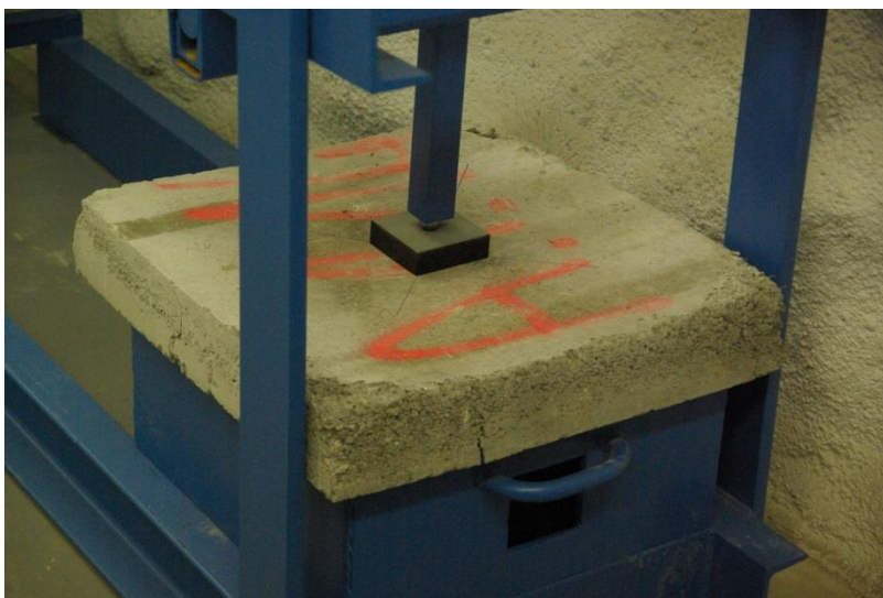
Abb.12 Auflagerrahmen und Belastungsstempel auf deformierter Spritzbetonplatte
