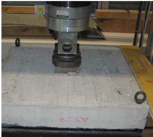
Abb.25 Rissinduktion in einem unterbrochenen Quadratplattenversuch nach SIA 162/6. Der Versuch wurde nach Erreichen der Grenzdurchbiegung von 3 mm gestoppt. links: Versuchsaufbau, rechts: Typisches Kraft-Verformungsdiagramm bei der Risserzeugung
