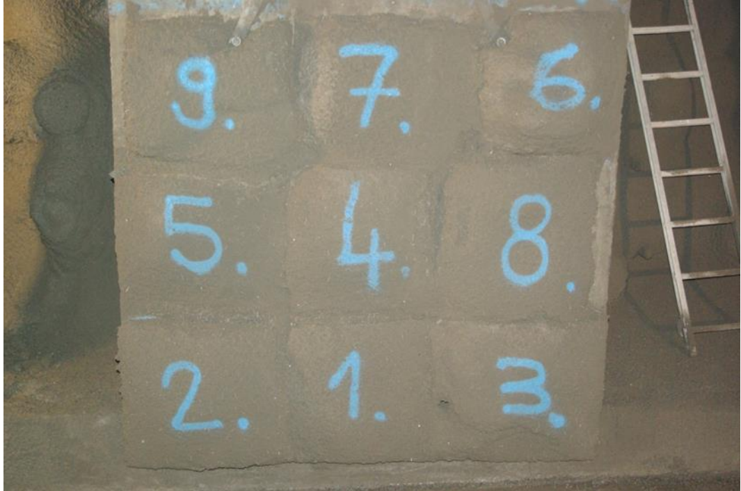
Abb.31 Spritzmuster zur Evaluation Einfluss Düsenabstand und Luftvolumenstrom
