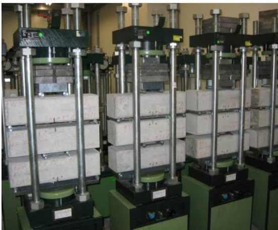
Abb.8 Prüfstände zur Kriechprüfung an Balken in der Empa
