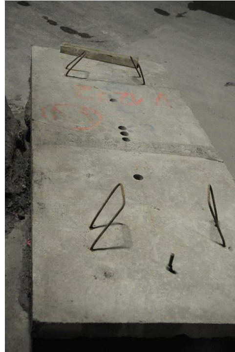
Abb.18 Entnahmestellen für Prüfkörper zur Bestimmung der Faserorientierung
