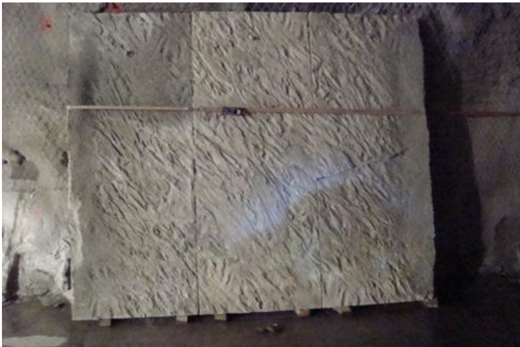
Abb.5 Versuchsanordnung von drei künstlichen Felsplatten vor der Spritzbetonapplikation
