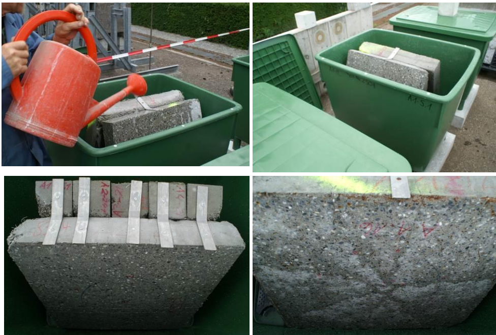
Abb.27 Beanspruchung mit verschiedenen wässrigen Lösungen durch Übergiessen der Prüfkörper (Quadratplatten für residuelle mechanische Belastungsversuche, Balken für Mikroskopie)
