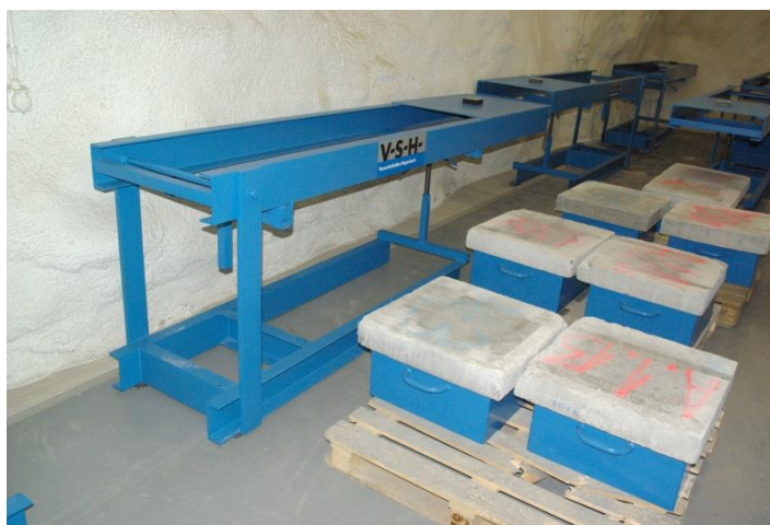
Abb.10 Prüfstand zur statischen Belastung vorgebrochener Faserspritzbetoplatte
