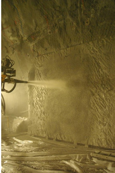
Abb.6 Versuchsanordnung zur Bestimmung des Rückpralls und des Faserrückpralls sowie zur Produktion der Proben zur Bestimmung der Faserorientierung
