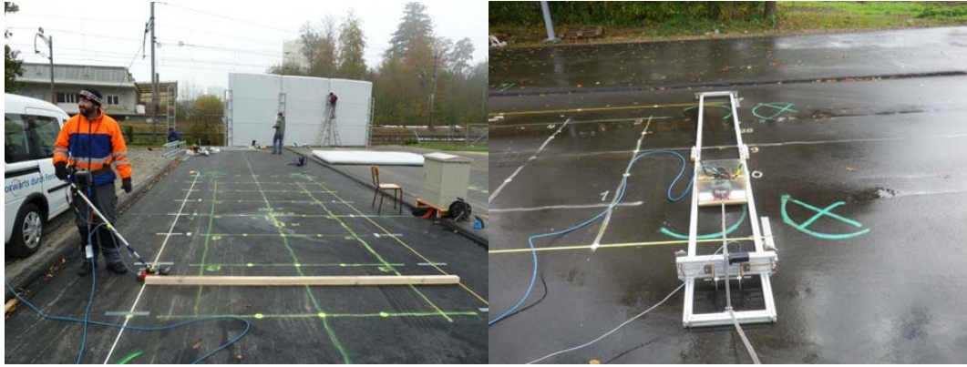
Abb. 49 Radarantenne auf dem Messfeld, Messkampagne vom 31.10.12 (links) und angepasste Messapparatur der Messkampagne vom 21.10.13 (rechts)
