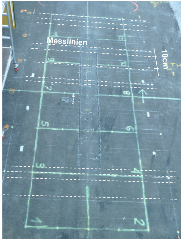
Abb. 12 Messgitter für die Inspektion des Belags mit Georadar
