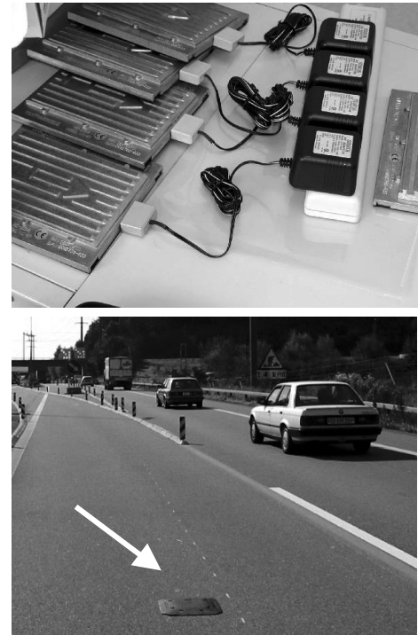
Abb. 2-12: NC97-Messplatte ohne Abdeckung (oben) und mit Abdeckung, befestigt auf der Fahrbahn (unten)
