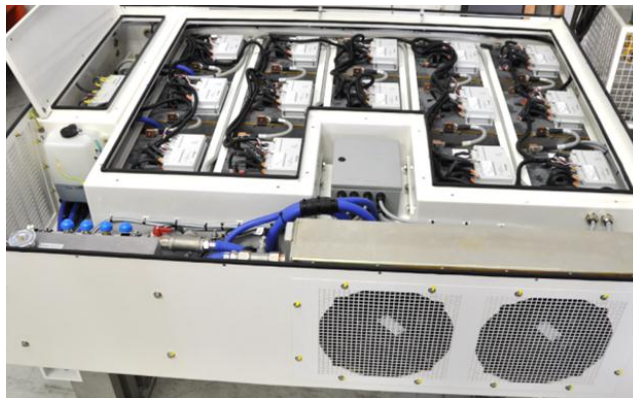
Fig. 6 La batterie Lithium Titanate installée sur le prototype TOSA
