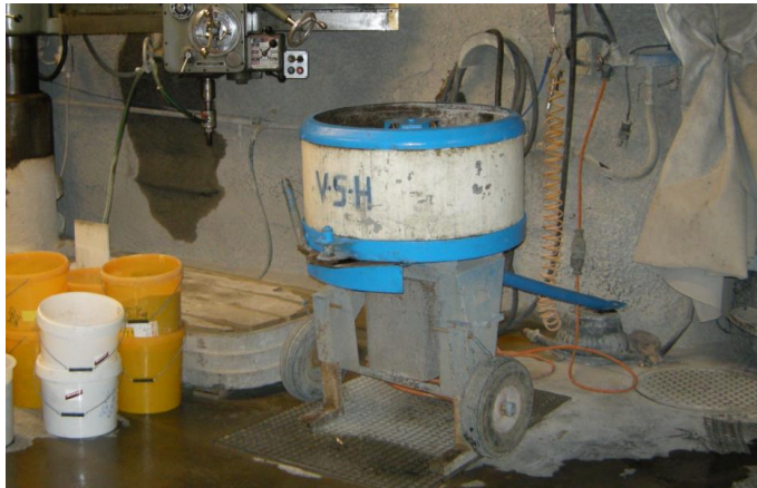
Abbildung 1 Zwangsmischer für Laborversuche
