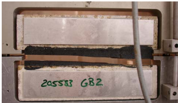
Abb. 4.2.3 Fugenmasse FM2. Aussehen der Fugen nach dem Versagen (Flankenablösung, Rissbildung) bei der Prüfung „Bestimmung des Dehn- und Haftvermögens bei diskontinuierlicher Dehnung“ gemäss EN 13880-13:2004.
