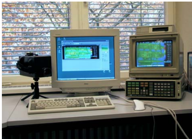
Abb. 17 Wärmebildkamera mit Auswertung am Monitor
