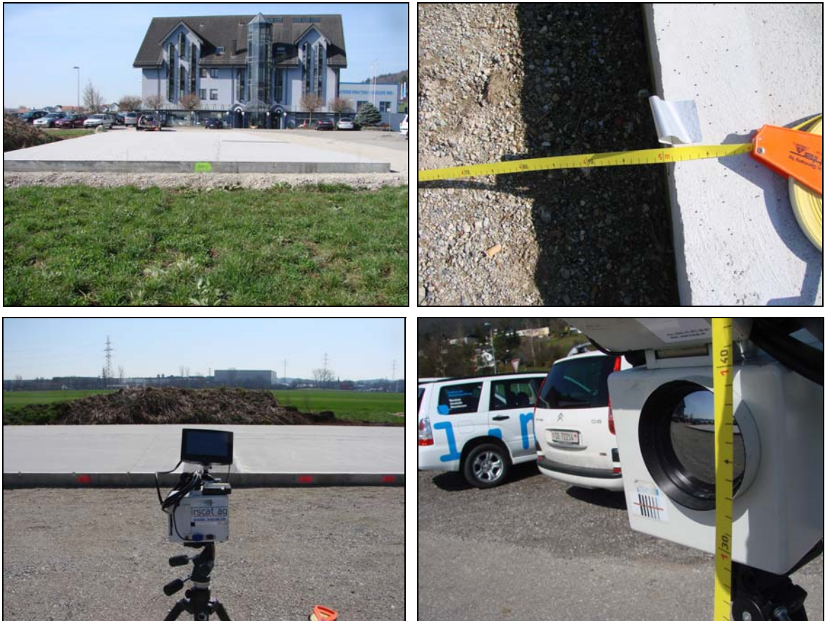
Abb. 18 Vermessen der Aufnahmestandorte für die Erstaufnahmen mit der IR-Kamera.
