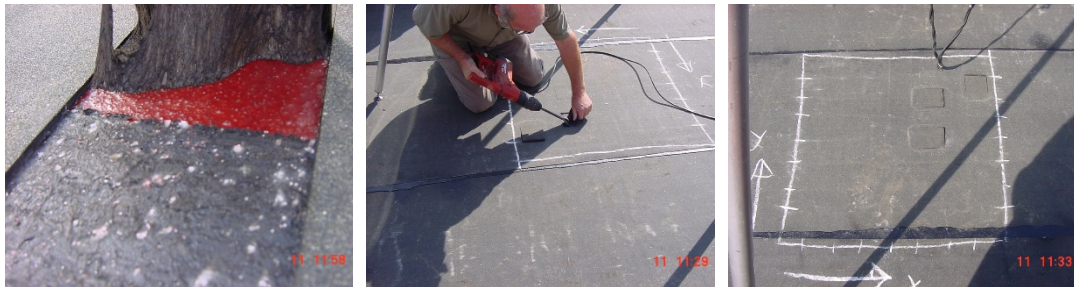
Abb. 62 Durchführung der Schälzugprüfung im Messfeld der Schallanalyse
