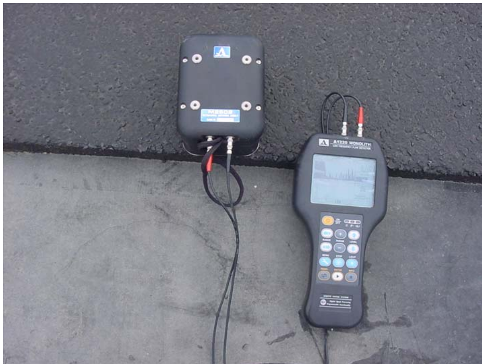
Abb. 50 Sender und Empfänger der Ultraschall-Messung
