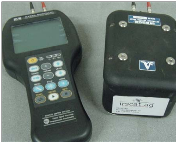
Abb. 21 Geräte des Ultraschall-Verfahrens; Speichergerät (links) und Messkopfeinheit (rechts).
