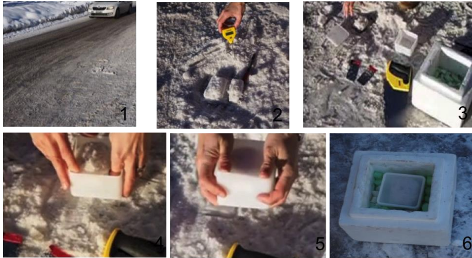
Abb. 9 Ablauf einer Schneeprobeentnahme auf der Strasse.
