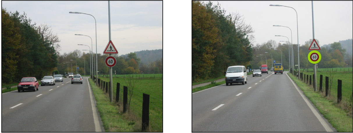
Abbildung 16: Signal 2.30 "Höchstgeschwindigkeit" ohne und mit gelber Hinterlegung
