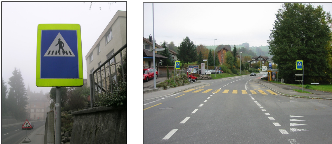
Abbildung 1: Beispiel gelb hinterlegtes Signal 4.11
