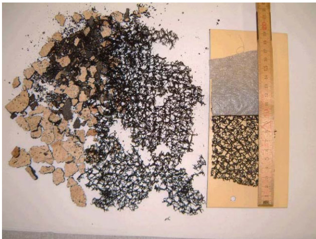
Abb. 57 Starke Zersetzungserscheinungen von Abdichtungssystemen nach Medienlagerung
