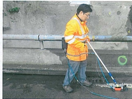
Abbildung 4: Georadar Messung mit 1.5 GHz Antenne
