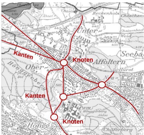
Abb. A-32: Anwendung der Graphentheorie auf ein Strassennetz
