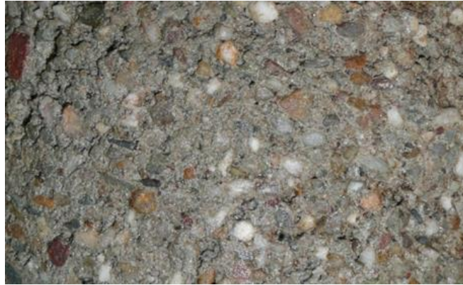
Abb. 17 Korngerüst eines Drainmörtels als Fertigprodukt mit Feinteilen 0 – 2 mm
