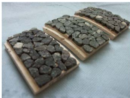
Abb. 3.15 Probekörper für PSV-Prüfung (aus [8])
