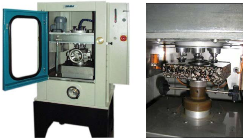
Abb. 3.34 Polier- und Griffigkeitsmessgerät (aus [8])
