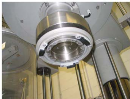
Abb. 3.20 Messkopf der Wehner-Schulze-Prüfmaschine
