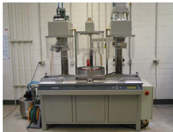
Abb. 3.18 Prüfeinrichtung nach Wehner-Schulze
