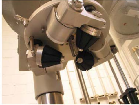
Abb. 3.19 Polierköpfe der Wehner-Schulze-Prüfmaschine
