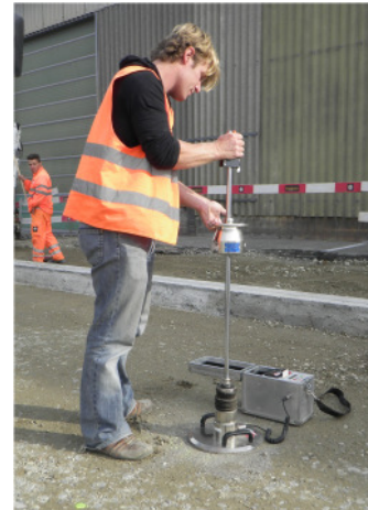
Auffangen des Fallgewichtes
