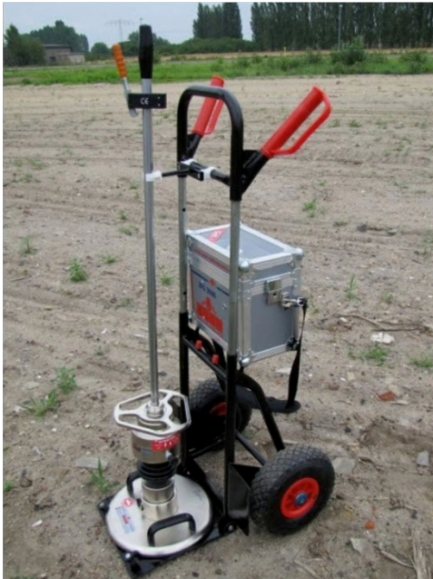
Abb. 10.35 Leichtes Fallgewichtgerät in Transportstellung
