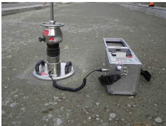
Abb. 5.10 Leichtes Fallgewichtsgerät: Lastplatte, Federelement, Fallgewicht, Setzungsmessgerät
