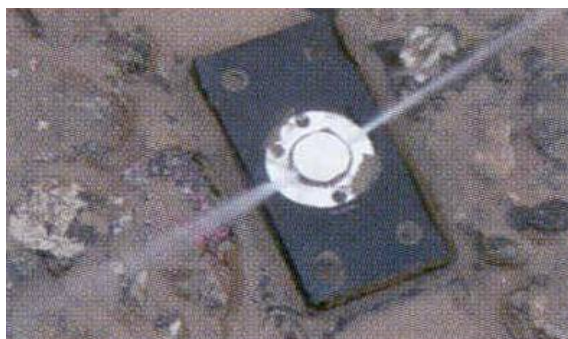
Abbildung 6: Mikro-Sprühkopf (Bildquelle: Boschung Mecatronic AG)
