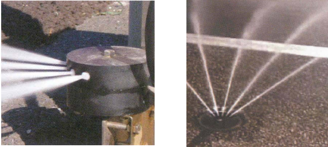
Abbildung 5: Verschiedene derzeit angewendete Sprüheinheiten: Sprühkopf (links), Sprühteller (rechts) (Bildquelle: Boschung Mecatronic AG)
