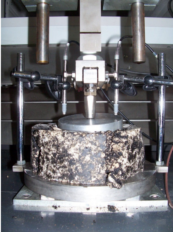
Abbildung 37: Kollaps eines Gyratorprüfkörpers, KMF.
