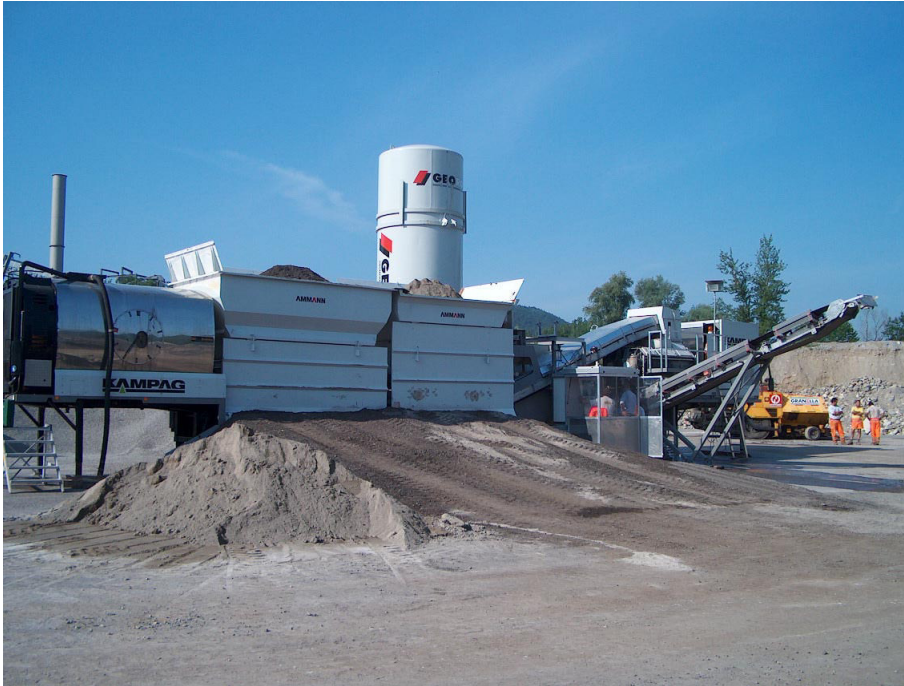
Abbildung 1: Mobile Kaltrecycling-Mischanlage, AMMANN CMC 130-200 t/h.
