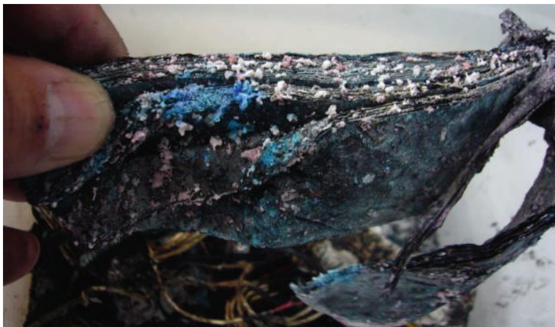
Abbildung 26: Batteriezelle (LMC) nach einem Brand. Die Zelle ist komplett ausgebrannt (alle organischen Komponenten wie Hülle, PE Separator Folie und Elektrolyt und auch die Graphit Elektrode). Während einer Reparatur am E-Scooter wurde die Zellenhülle mit einer Schraube durchstossen. Der innere Kurzschluss entzündete nach einigen Minuten die freigesetzten Gase. Weder Wasser noch Schaum- und Staublöcher vermochten den Brand vollständig zu löschen – erst als die Zellen vollständig entladen waren, stoppte der Schwelbrand; deutlich sieht man das blaue Kupfersulfat, das sich durch die Löschmittel bildete. (Bild: Empa)
