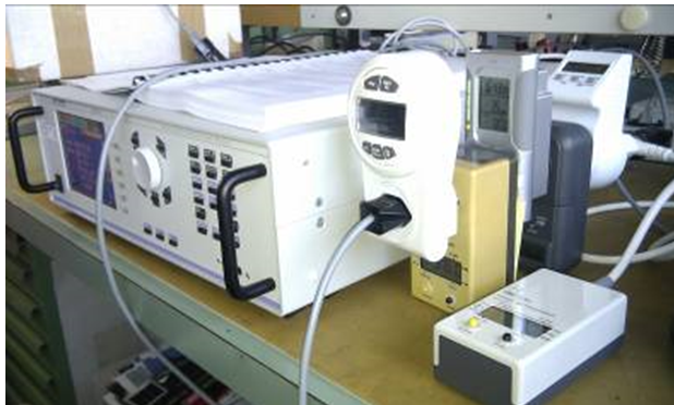
Abbildung 17: Messeinrichtung mit der verwendeten Last (Quantya Ladegerät und Batterie) sowie den, in Serie geschalteten Stromkostenmessgeräten und dem Referenzmessgerät ZES LMG500.
