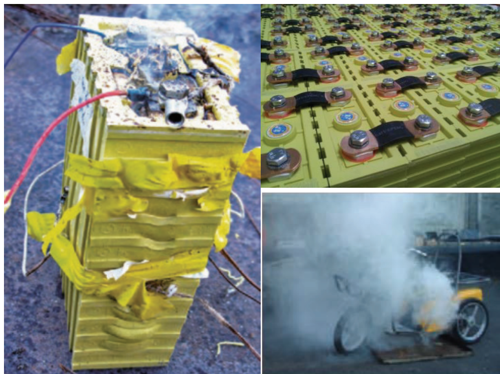
Abbildung 24: Brandversuche von Li-Bat an der Empa. (links) Batteriezelle (LiFePO 4 ) nach einem Nagel-Durchdringungstest. Der innere Kurzschluss führt zu starker Erhitzung und dem Entweichen von Gasen, die sich hier jedoch nicht entzündeten. (rechts oben) Batteriepaket mit gut sichtbaren (blaue Zapfen zwischen den Kontakten) und freien Überdruckventilen. (rechts unten) Brandversuch durch Batteriekurzschluss in einem Kyburz E-Scooter. Deutlich ist die starke weisse Dampfentwicklung durch den überhitzten Elektrolyten zu sehen. Der Dampf hat sich jedoch nicht entzündet, mit einem elektrischen Funken wäre dies jedoch leicht möglich. (Bilder: Empa)
