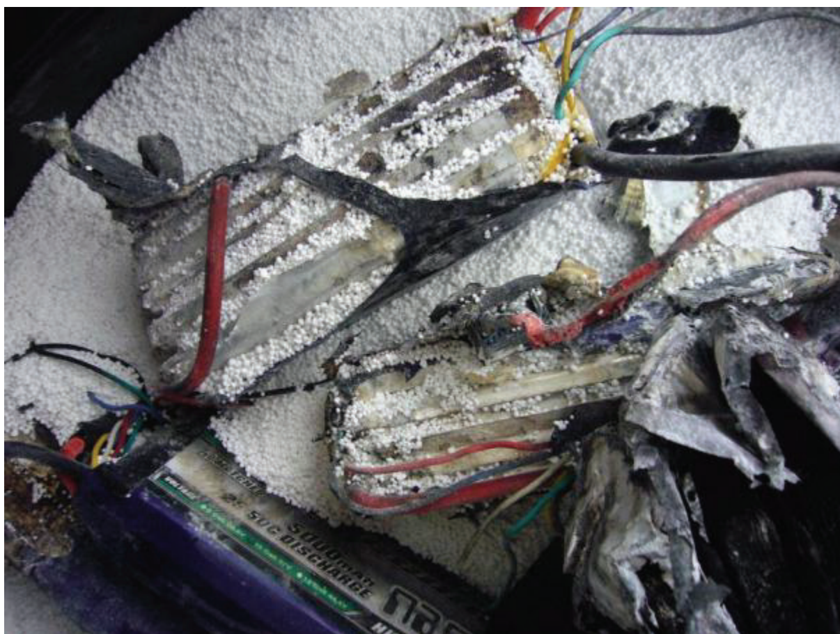
Abbildung 27: Brandschutzmassnahmen mit inertem Füllstoff. In Brand gesetzte Batteriepakete werden zum Ersticken und Abklingen der chemischen Reaktionen und zum Abkühlen in einem INOBAT-Fass, gefüllt mit Py-
