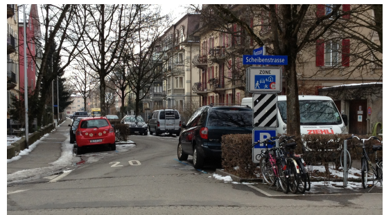
Abb. 5.26 Flurstrasse Bern Die Torsituation wurde mit einer Fahrbahnverengung mit Schrägparkierung erwirkt. Durch den Baum wird die Wirkung verstärkt.
