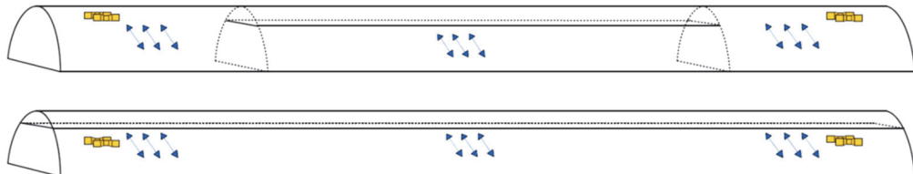
Tunnel mit Absaugung und Abluftkanalabschnitt > 1000 m
