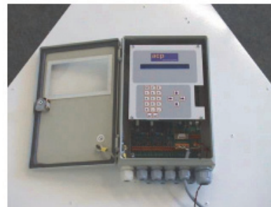
CDU, Auswerteeinheit Anschluss bis zu 64 Sensoren über serielle Schnittstelle möglich 4 x 4-20mA Ausgänge, erweiterbar bis 8 4 x Relaisausgänge, erweiterbar bis 8 serielle Schnittstelle RS 485 oder ProfiBus DP Stahl-Wandgehäuse oder als 19" Rack erhältlich
