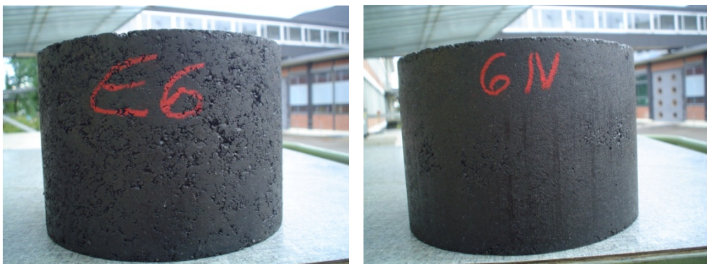
Abbildung 12: Gyratorprüfkörper der Serie N1 und E6 mit unterschiedlichem Hohlraumgehalt
