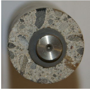
Abb. 3.4 Bohrkern mit Durchmesser 28 mm, Blick auf die Stirnfläche mit aufgeklebtem Messbolzen für die Längenmessung.
