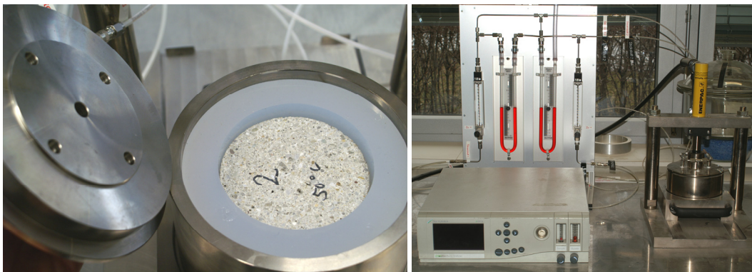
Abb. 3.5 Probe in Prü fzelle mit Silikondichtring (links), Prü fanordnung für die Bestimmung des Sauerstoffdiffusionskoeffizienten (rechts).
