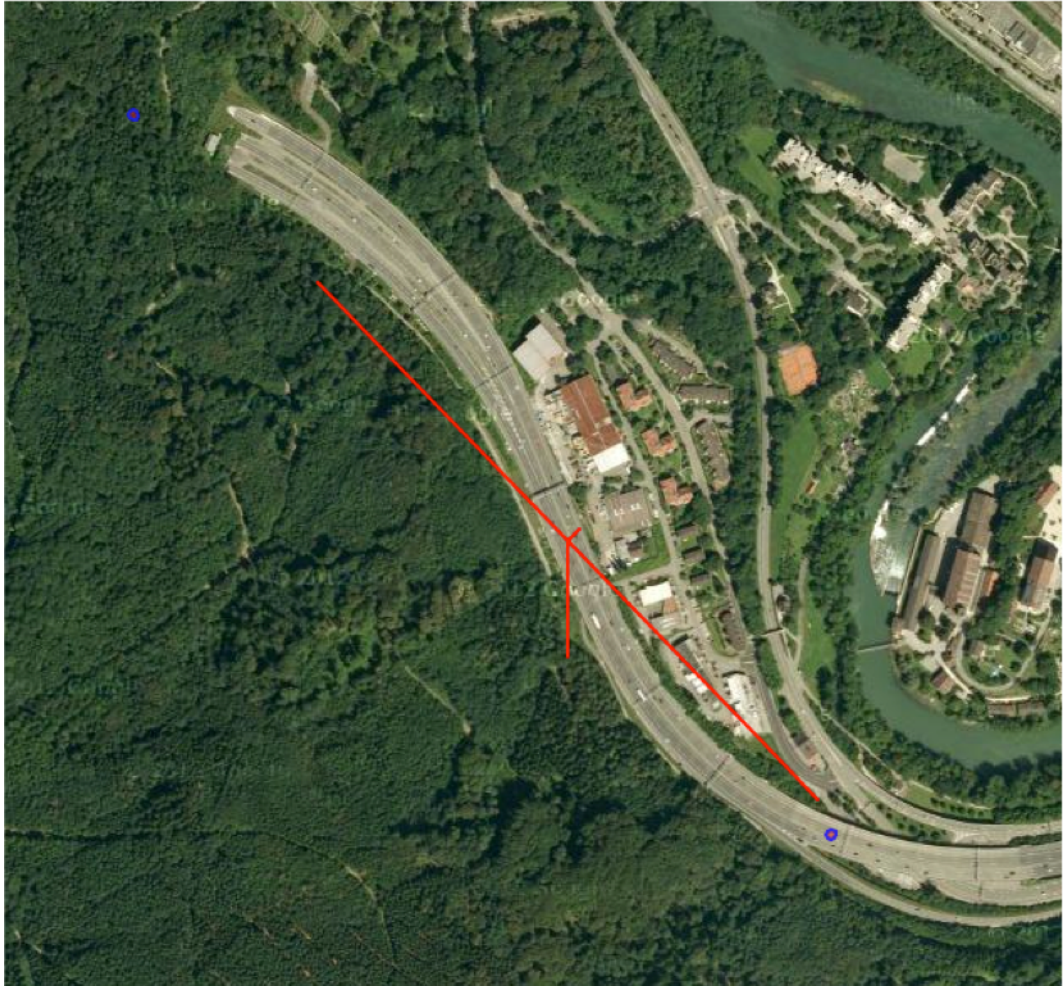
Abb. 4.6: Visualisierung der RBBS-Daten zu einer LSW (rot), im Vergleich zu einer realen Luftbildaufnahme des Strassenverlaufs (Quellen: TNC, google maps)
