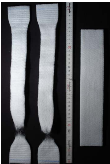
Abb. 4.10 zeigt wie Geovliese und Geogewebe beim Zugversuch unterschiedlich reißen. Beim Geovliese im linken Bild liegt die Rissstelle am unteren Klemmbackenrand. Das Geogewebe im rechten Bild zeigt über die ganze Fläche zerrissene Fäden.
