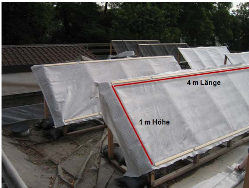
Abb. 4.6 Anlage Freibewitterung mit Neigung 45° und Südwestexposition (210°)
