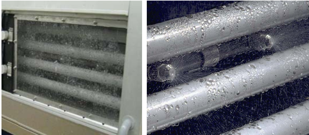
Abb. 4.5 Das linke Bild zeigt die Anlage ohne Prüfmuster beim Besprühen. Das rechte Bild zeigt im Detail zwei von gesamthaft 12 Spritzdüsen in Funktion.
