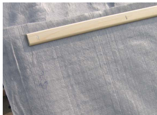
Abb. 4.7 Die Geokunststoffe wurden auf ein Geogitter (linkes Bild) für die Freibewitterung aufgespannt und mit einer Fixierleiste (rechtes Bild) unten und oben fixiert.
