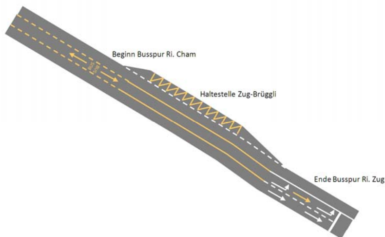
Abb. 2.4 Skizze Beginn resp. Ende Richtungswechselbetrieb
