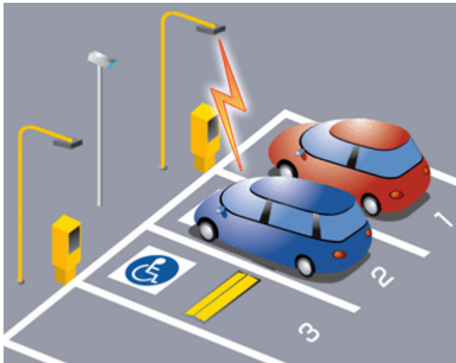
Abb. 3.18 Automatisiertes Bewirtschaftungssystem für Parkierung mit Sonderberechtigung (hier: Gehbehinderte); [Quelle: www.oki.com , Products > ITS Solutions > DSRC technology]
