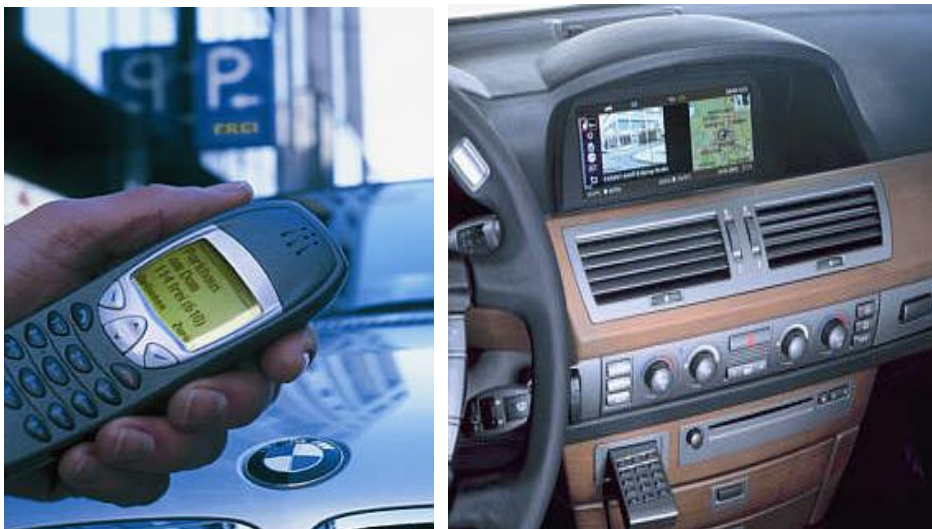
Abb. 3.20 Online-Informationen zur Parkplatzverfügbarkeit via WAP-Mobiltelefon oder Internet-Zugang im Fahrzeug: Fotos aus www.7-forum (Juli 2008)
