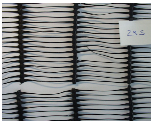
Abb. 100 Zustand der in Sand eingebauten Probe eines gereckten Gitters (Muster Nr. 29).
