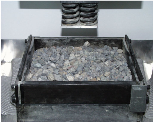
Abb. 81 Einbringen der oberen Bodenschicht.
