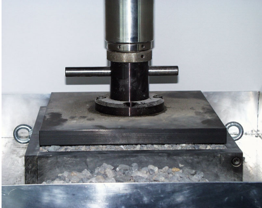
Abb. 79 Verdichtung der unteren Bodenschicht.
