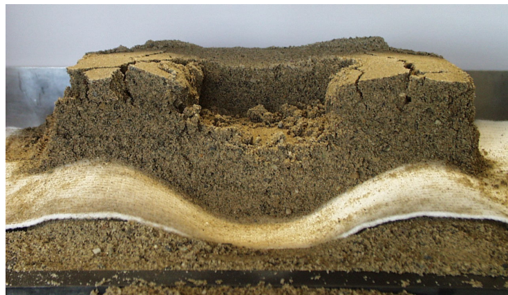
Abb. 107 Verformung des Geokunststoff-Streifens nach einer Einbaubeanspruchung im Labor mit Sand.
