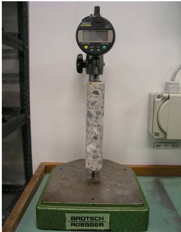
Abb. 2.2 Messapparatur zur Bestimmung der Längenänderung nach der Sulfatlagerung. Prüfkörper mit aufgeklebten Bolzen zur genauen Längenmessung.
