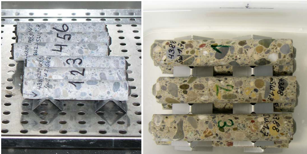
Abb. 2.1 Trocknen der Proben im Ofen nach jeder Sulfatlagerung (links) und lagern der Prüfkörper in der Sulfatlösung (rechts).
