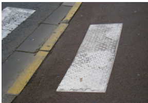
Abb. 4.38 Beispiele aus dem Ausland sowie Versuchsanordnung TCS Lausanne: markierte Kopfelemente im Halteraum
