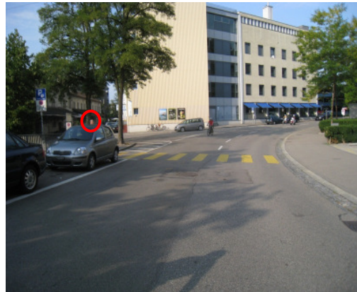
Abb. 4.34 Beispiel: fehlende Sichtweite nach links (Fussgänger versteckt hinter dem PW)
