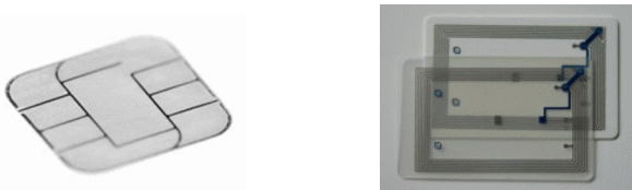
Abb. 4.11 Chipkarten Typen: Kontaktbehafteter Chip (links); Kontaktlose Chipkarten (rechts)
