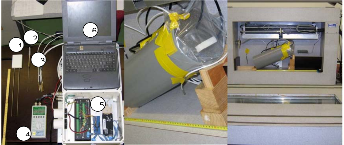
Abb. 10 Experimentelle Bestimmung der thermodynamischen Parameter, Messsensoren und Datenerfassung; links: TDR Sonde (1), NSSP Sonde (2), Temperatursensoren (3), Mehrkanalthermometer mit hoher Genauigkeit (4), Datalogger (5) und Laptop (6); PVC-Zylinder mit eingebauten Messgebern (mitte); geöffnete Klimakammer mit Probe (rechts)
