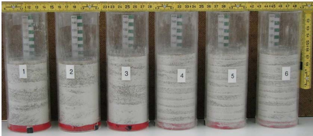
Abb. 118 Proben der Serie 8 vor der Sättigung: Proben 1 bis 3 sind homogen, während die Proben 4 bis 6 geschichtet verdichtet worden sind
