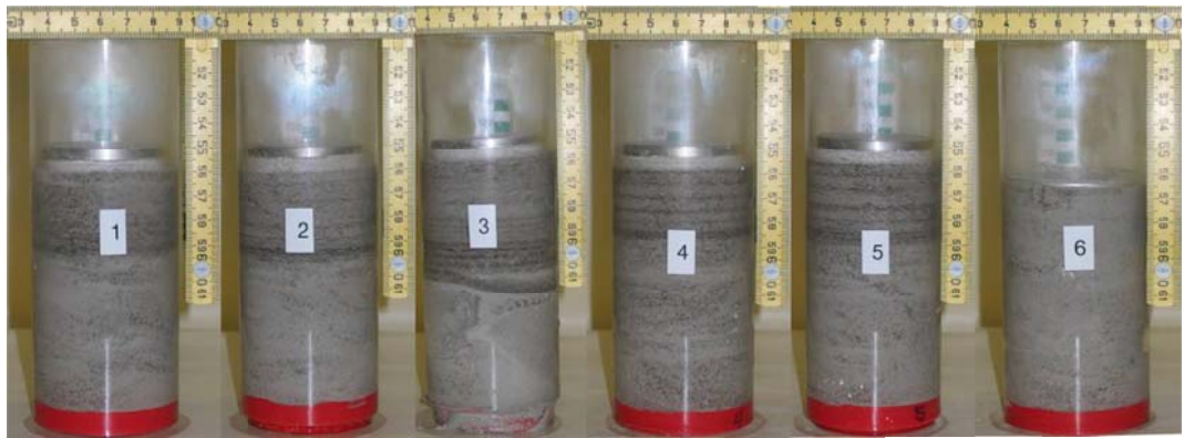
Abb. 101 Proben der Serie 4 nach dem Frosthebungsversuch (Mischungen Sand und Kalkmehl)
