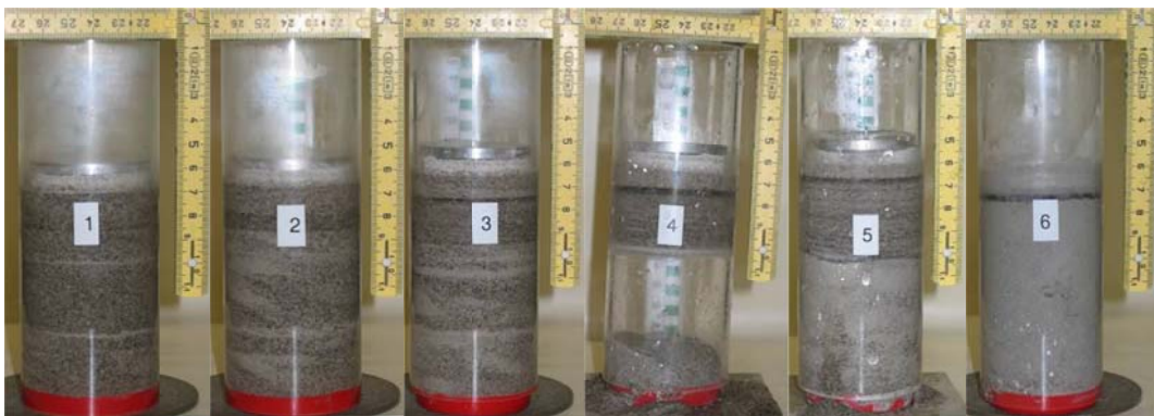
Abb. 99 Proben der Serie 2 nach dem Frosthebungsversuch (Mischungen aus Sand und Basaltmehl)
