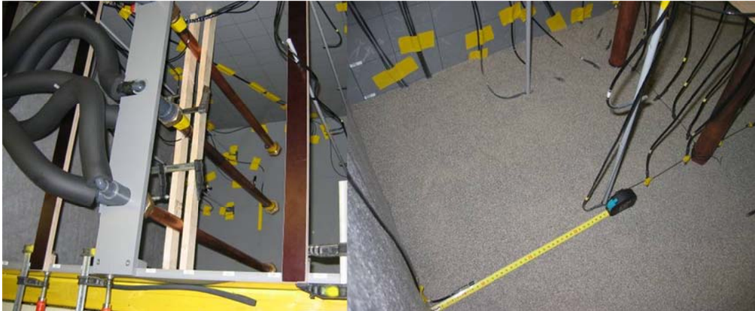
Abb. 20 Grossmassstäbliches Modell mit Sensoren vor dem Sandfüllen (links) und im bis zur Messebene halbgefülltem Zustand (rechts)
