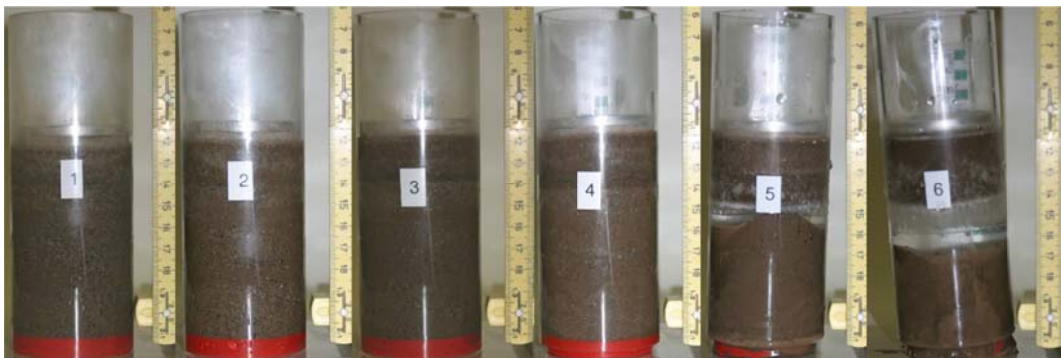
Abb. 99 Proben der Serie 2 nach dem Frosthebungsversuch (Mischungen aus Sand und Basaltmehl)
