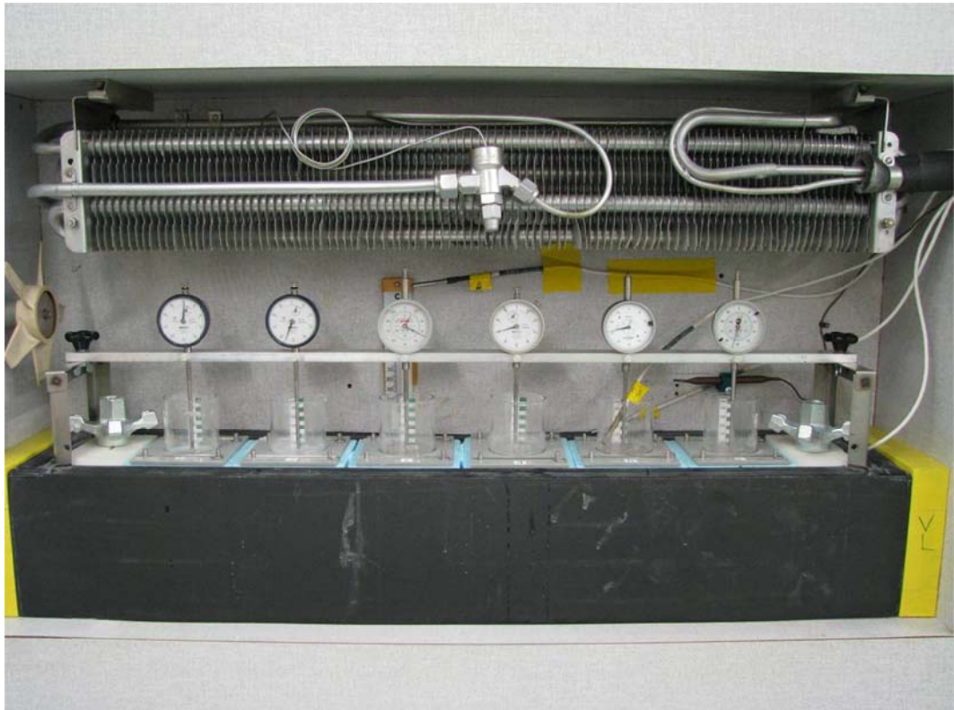
Abb. 96 Prinzipische Skizze (oben) und Bild (unten) der Versuchsanlage für die Vorversuche: Probe in Versuchseinheit (1), Messuhr an Gestell befestigt (2), Wärmedämmung (3), Wasserbad (4), Wasserzufuhr (5), Magnetventil (6), Wasserabfluss (7), Kühlaggregat (8), Wärmetauscher (9), Lüfter (10), Aussenrahmen und Wärmedämmung (11), Sensor T-Luft (12), Sensor T-Luft-Probe (13) und Sensor T-Wasser (14)
