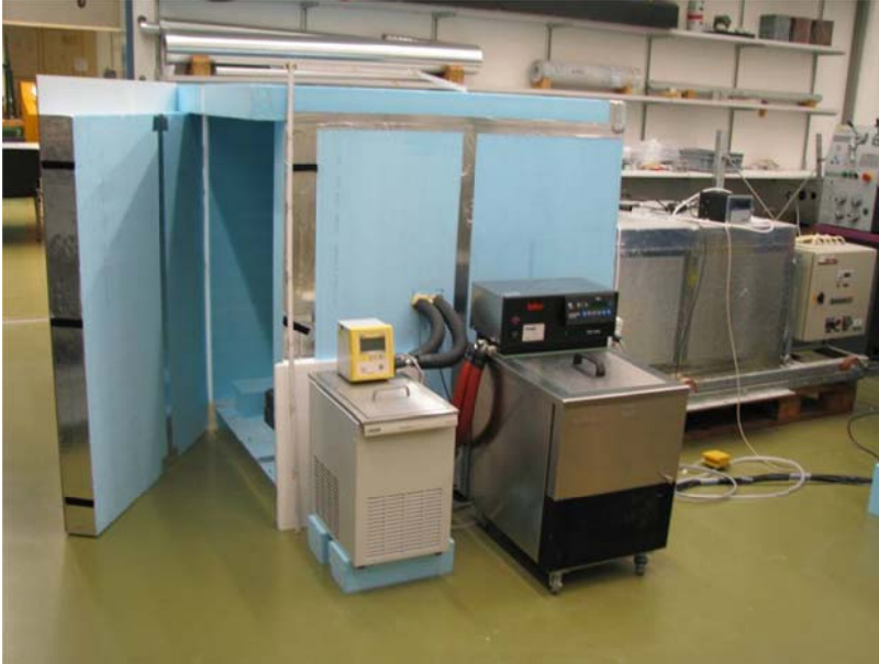
Abb. 105 Klimakammer und Kühlaggregate
