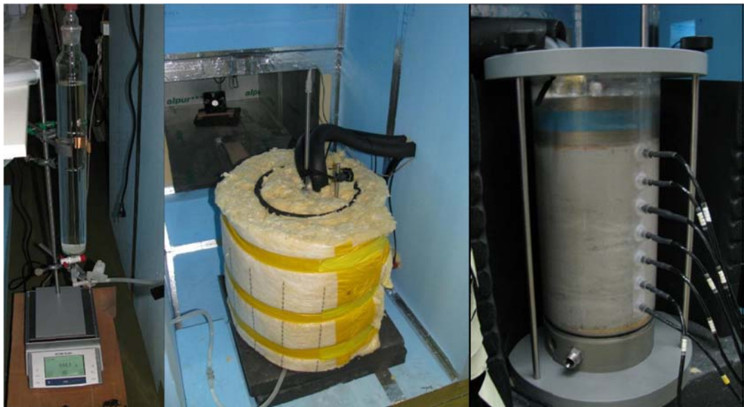
Abb. 104 Mariotteflasche und Präzisionswaage (links), Elementversuch mit Wärmedämmung in der Klimakammer (Mitte) und Elementversuch ohne Wärmedämmung (rechts)
