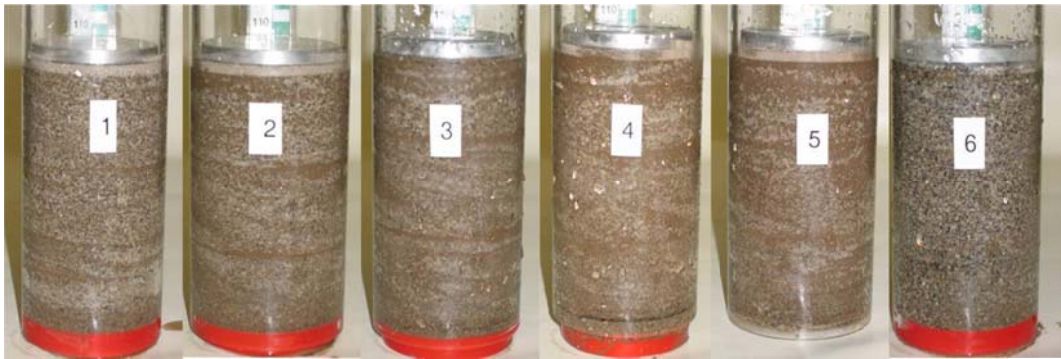
Abb. 98 Proben der Serie 1 nach dem Frosthebungsversuch (Mischungen aus Sand und Basaltmehl)
