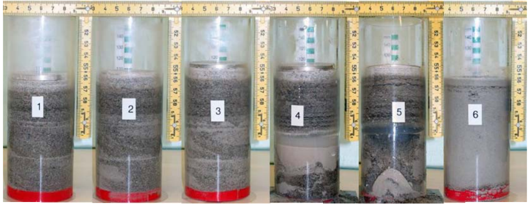
Abb. 101 Proben der Serie 4 nach dem Frosthebungsversuch (Mischungen Sand und Kalkmehl)
