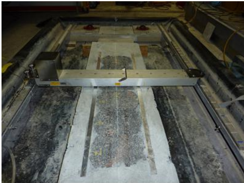
Abb. 5.2.5 Profilometer zur Bestimmung der Spurrinnentiefe
