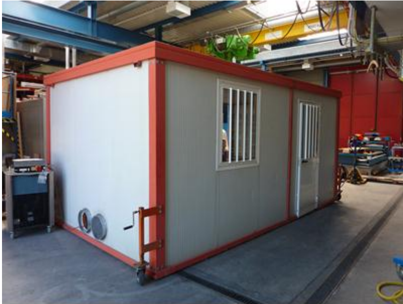
Abb. 5.2.4 Container zur Temperierung während der Prüfung mit Verkehrslastsimulator
