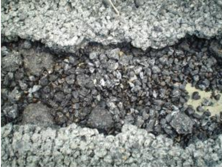
Abb. 3.1 Stripping eines offenporigen Asphaltprüfkörpers infolge der Untersuchung mit dem mobilen Modell-Verkehrslastsimulator MMLS
