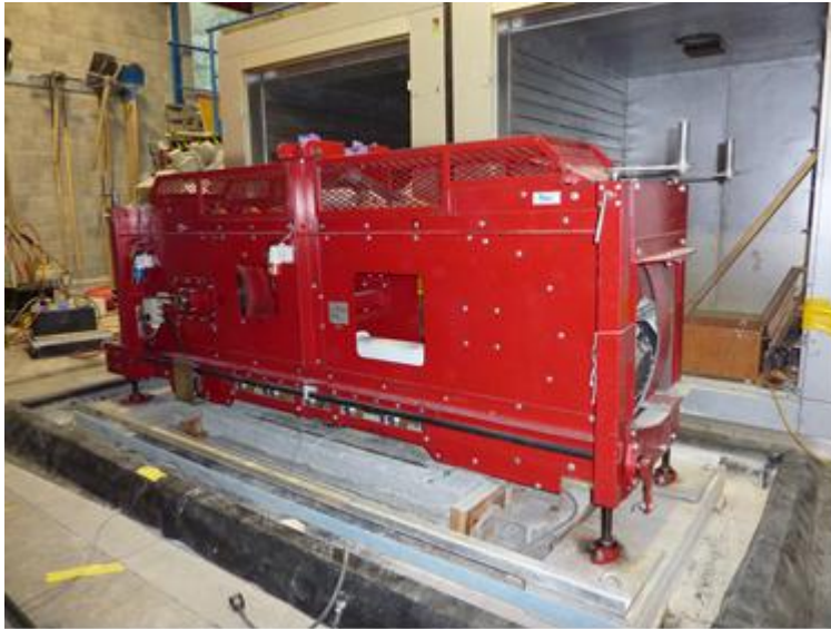
Abb. 5.1.1 Mobiler Verkehrslastsimulators MMLS3 im Maßstab 1:3
