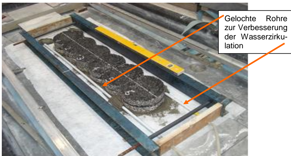
Abb. 5.2.2 Prüfkörper, aus 6 zugeschnittenen Bohrkernen der Breite 150 mm
