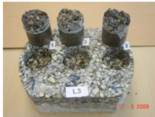
Abb. 6.3.1 Anordnung bei Haftzugprüfung: a) Schematische Darstellung, b) Foto
