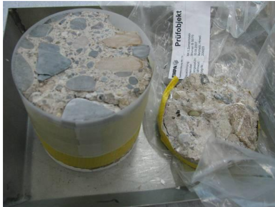
Abb. 4-5: Die Probe wurde verpackt abgeschnitten, damit sie nicht zerfällt.
