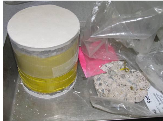
Abb. 4-6: Die Oberflächen wurden mit Gips prepariert.
