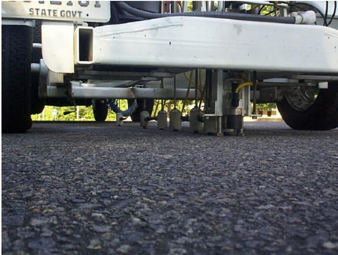
Abb. 1-6: PSA, Schwingende Masse und Geophone
