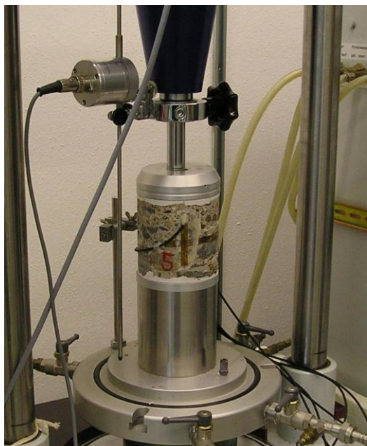
Abb. 4-7: Die DMS wurden mit Epoxydharz auf die Probe geklebt.
