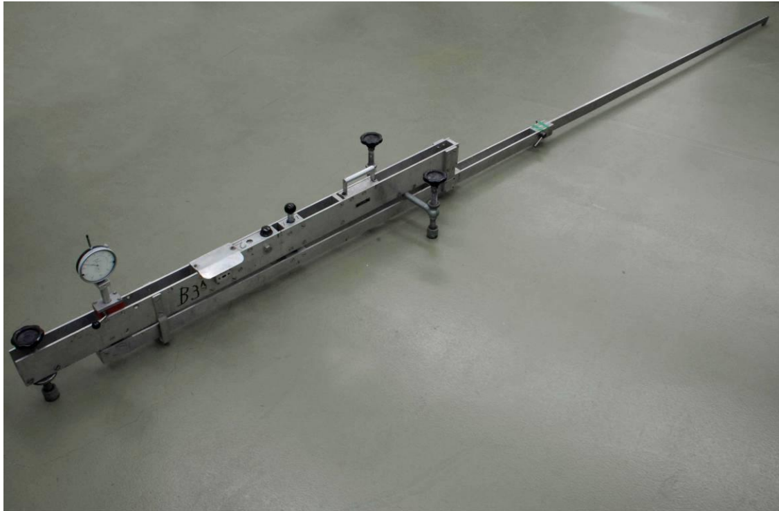
Abb. 1-7: Benkelman Balken: die Einsenkung ist mit dem Wegaufnehmer (links) mittels dem Hebelarm Prinzip gemessen.
