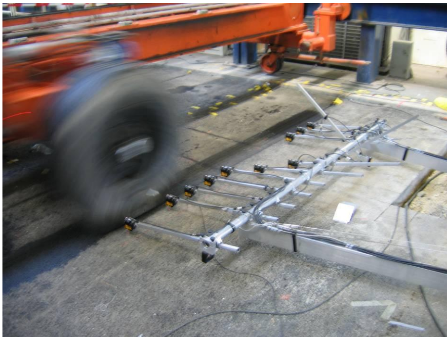
Abb. 3-7: Versuch mit rollendem Rad: Die Sensoren sind in Querrichtung versetzt um die Ausbreitung der Mulde in Querrichtung zu messen.
