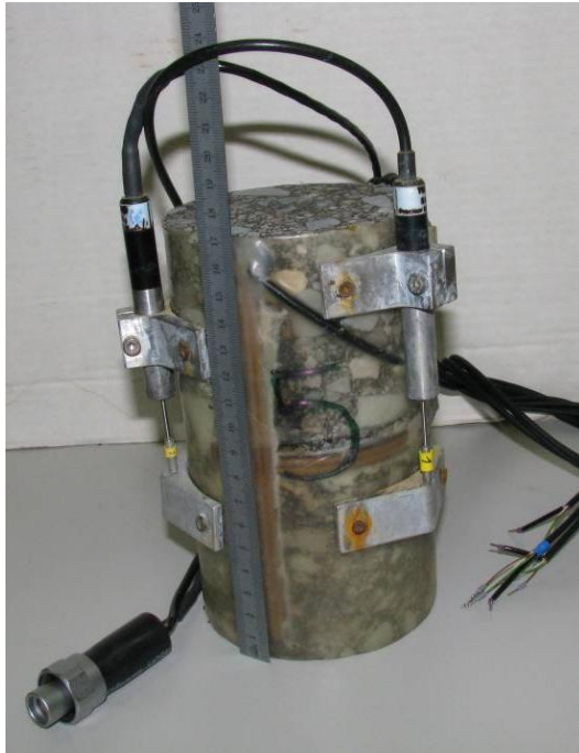
Abb. 4-17: Versiegelte Probe mit LVDTs und strain gauges (core C)
