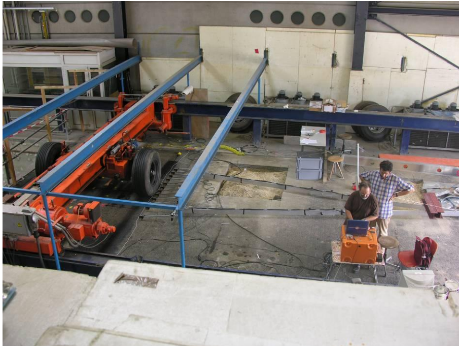
Abb. 3-6: Die Achslast und das ETH Delta, das parallel zum Belastungspfad positioniert wurde (Pos. B)
