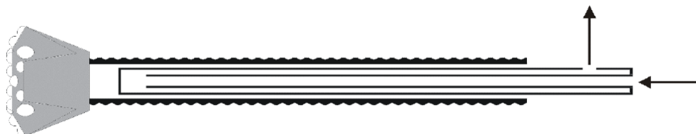
Abb. 2.14 Schematischer Aufbau eines Energieankers mit Koaxialsonde [8]
