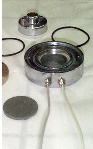
Figure 9.2: Détail des micro tubes, de l'embase inférieure et de la pierre poreuse inférieure du pot œdométrique CRS
