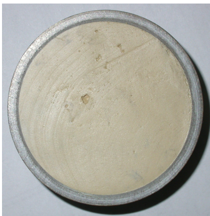
Figure 9.3: Eprouvette carottée correctement, le sol rempli complètement la bague de l'œdomètre
