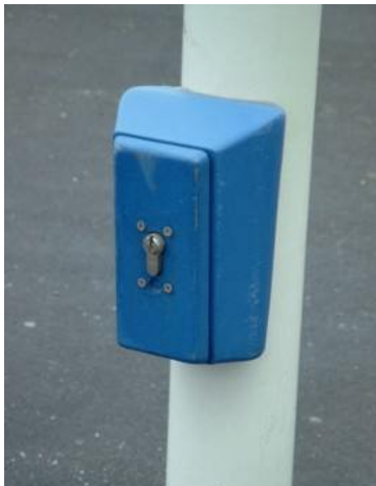
Abbildung 14: Schlüsselschaltung als Verkehrserfassungssystem
