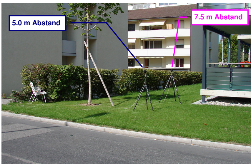
Abb. 5.5: Messaufbau Parallelmessung (7.5 m / 5.0 m Abstand zur Strassenachse)
