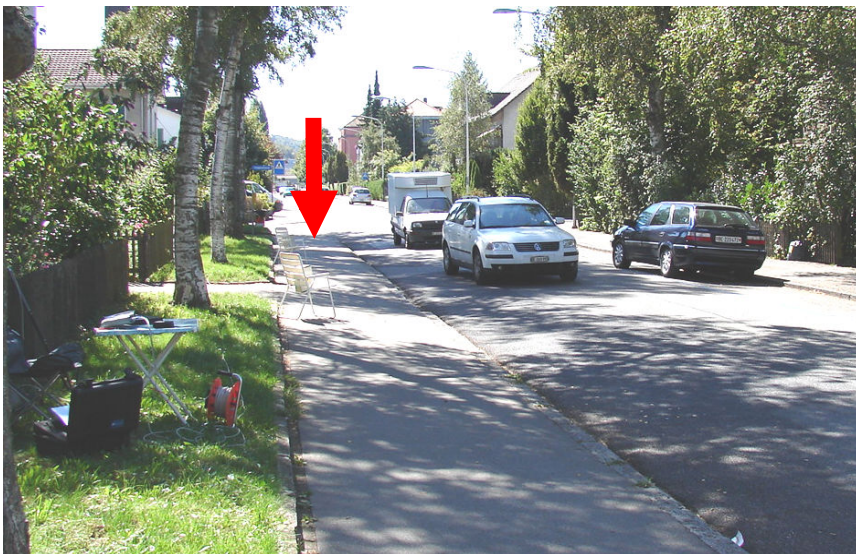
Abb. 5.4: Radar- und Lärmmessungen am Strassenrand
