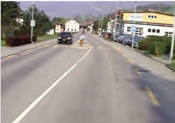
Abbildung A3.51: Die Hecke rechts verdeckt herannahende Schulkinder
