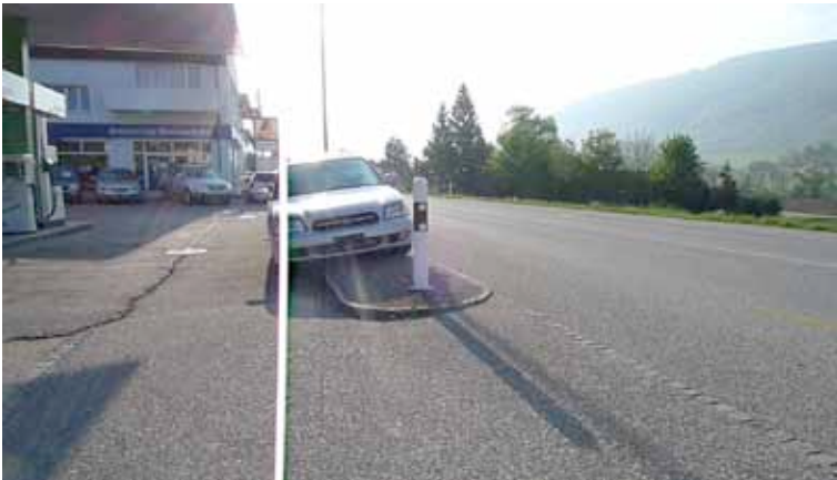
Abbildung 4.34: Fahrzeuge verdecken bei der Tankstellenausfahrt die Sicht auf die Strasse.
