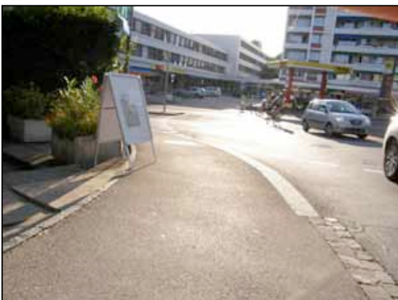
Abbildung 4.15: Durch Hecke eingeschränkte Sicht auf den Warteraum beim Fussgängerstreifen.
