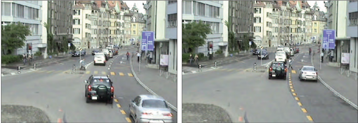
Abbildung A3.10: Schüler werden bei diesem FGS mit gleichgerichteter Doppelfahrbahn vom links haltenden Fahrzeug verdeckt.
