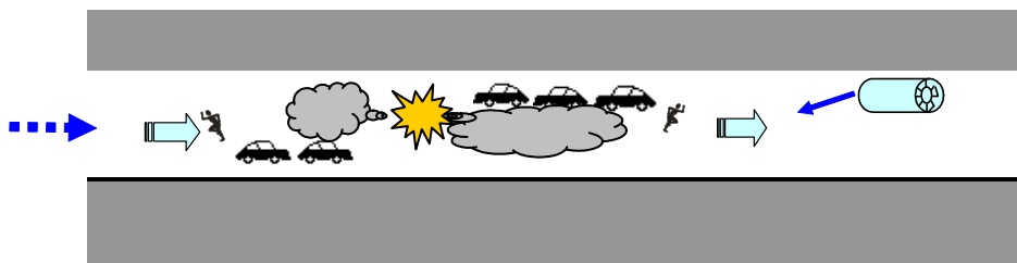
Abbildung 1.2 Längslüftung, Bremsen der Luftströmung
