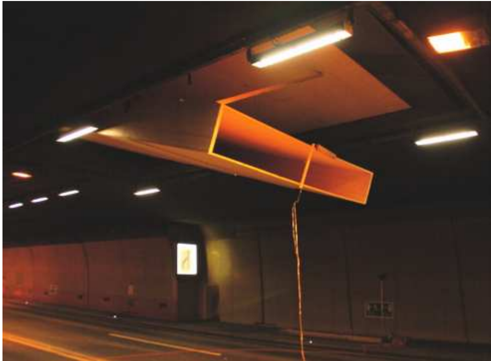
Abbildung 4.9 Seitenansicht der Saccardo-Düse aus Holz
