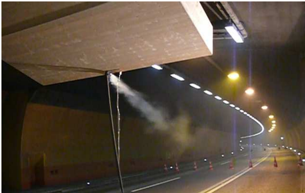
Abbildung 4.15 Strömungsbild Saccardo-Düse mit Rauchblasung
