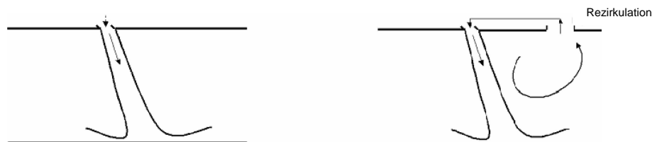
Abbildung 2.10 Prinzip nicht rezirkulierender und rezirkulierender Luftschleier
