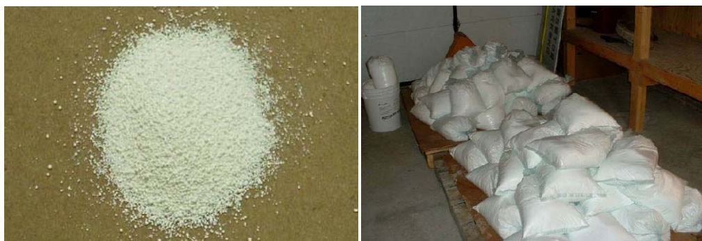
Figure 10-1 : Zéolithe pour enrobé à l'Aspha-min (gauche) et sacs thermofusibles pour centrale discontinue (droite) [55]
